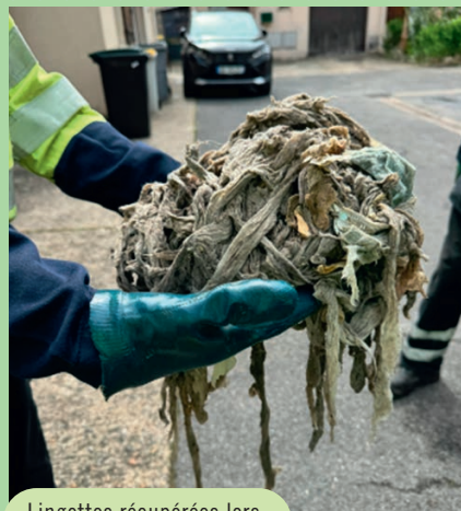
Lingettes récupérées lors d'un nettoyage de réseau.
